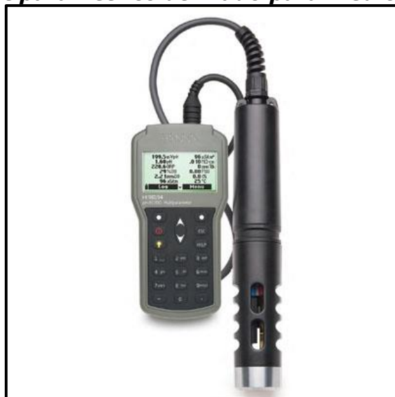
Fotografía N° 2: Equipos multiparamétrico utilizado para mediciones in situ .
